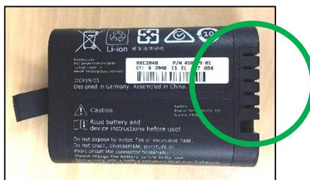
2. Allineare le scanalature con i piedini all'interno della stazione di ricarica e spingere con cautela verso il basso per inserire a fondo la batteria sui piedini.
